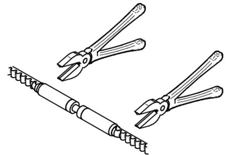
Wenn Ihr alter Antrieb bereits mit einem Zahnriemen ausgestattet ist, Schneiden Sie den verpressten Mitnehmer bündig aus dem Zahnriemen.
