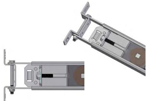
Führen Sie den Zahnriemen durch die Kopfseitige Umlenkung.
