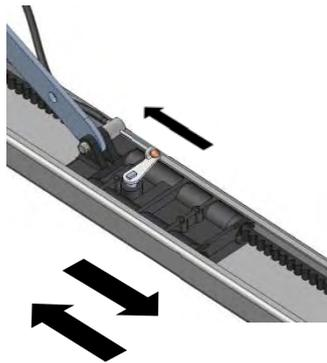
Zahnriemen an der vorderen Umlenkung mittels der Spannmutter lösen.
