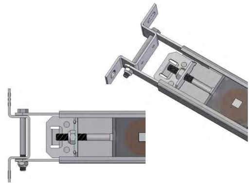
Rasten Sie den Laufschlitten auf dem Mitnehmer ein und Prüfen Sie den Lauf des Zahnriemen indem Sie den Laufschlitten in der Schiene manuell bewegen.
