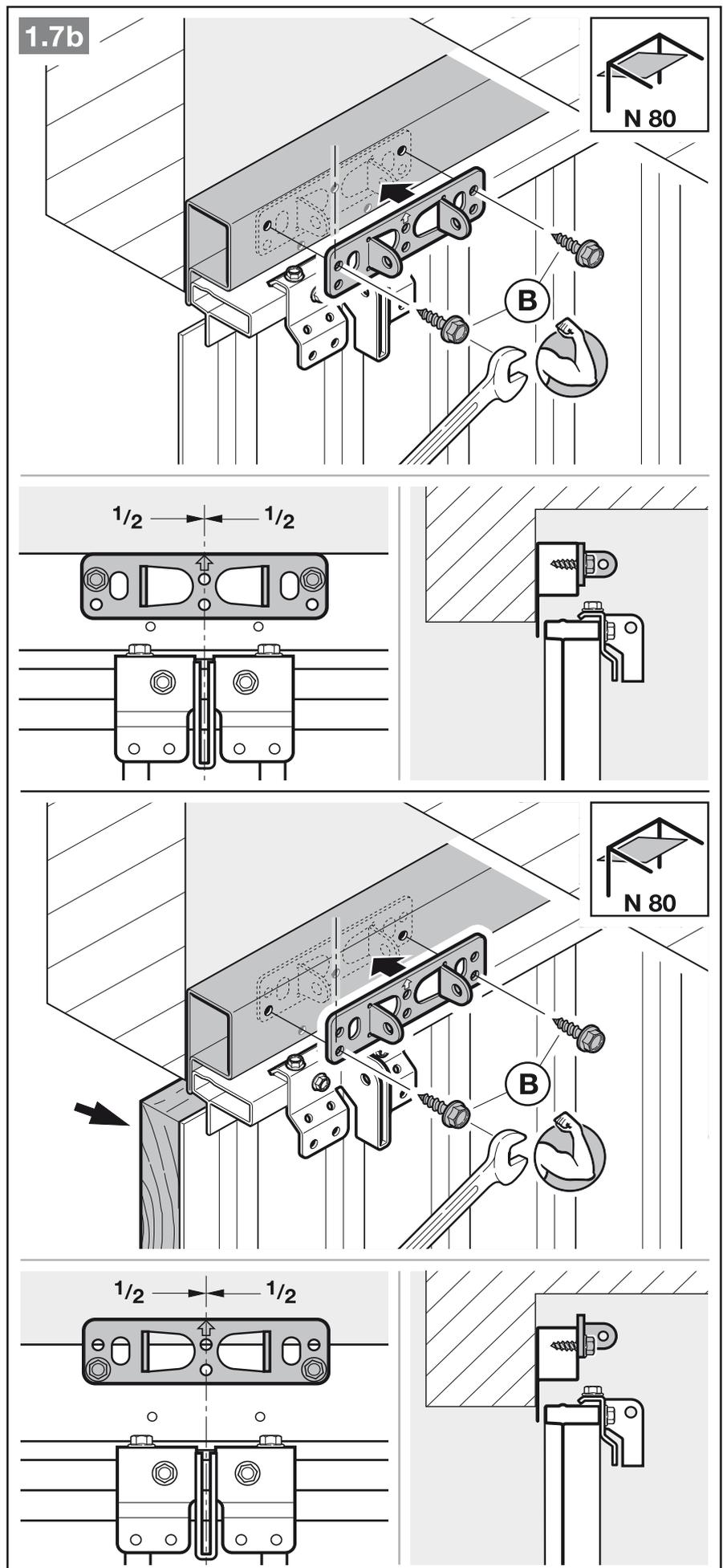
3.4 Führungsschiene montieren
