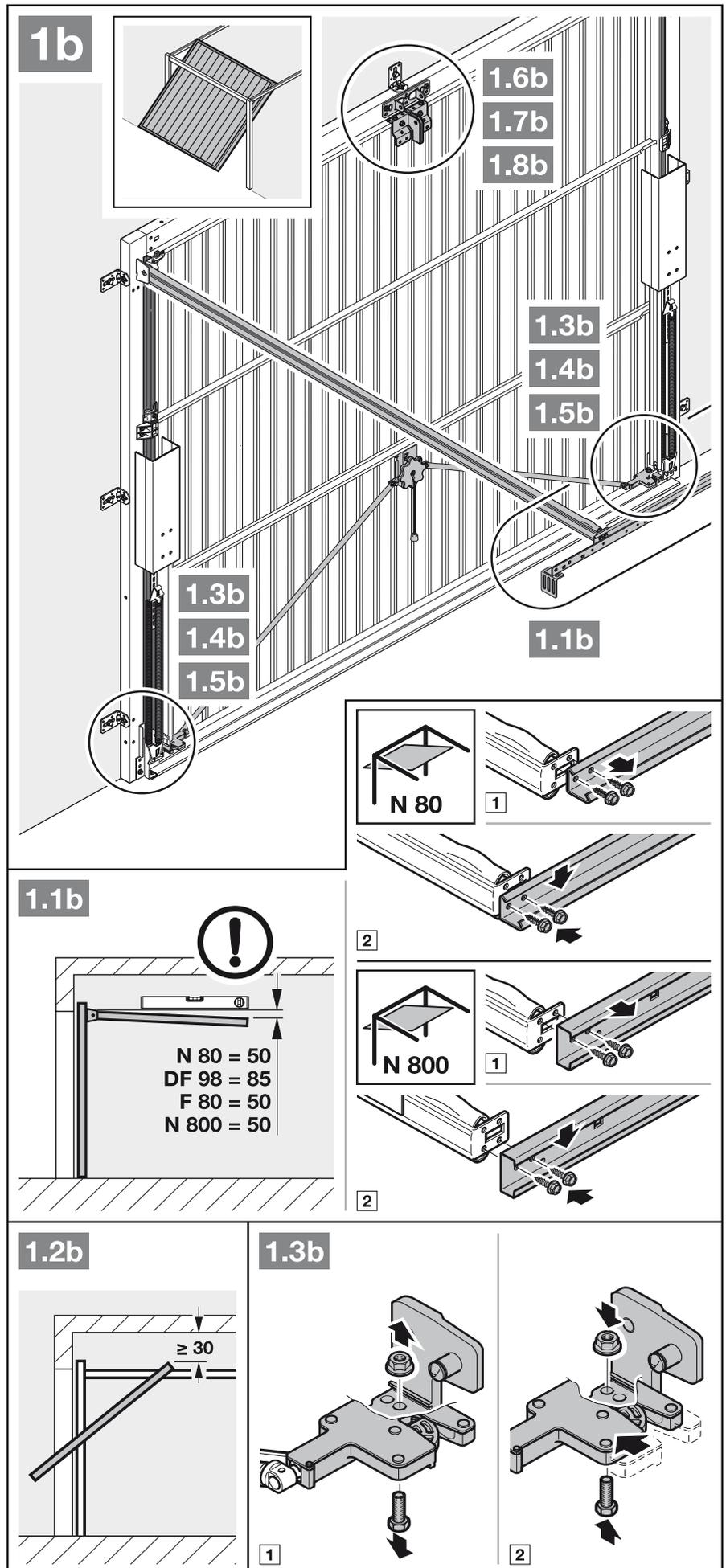
5. Setzen Sie die mechanischen Torverriegelungen außer Betrieb (siehe Bilder 1.4b/1.5b). Stellen Sie bei den hier nicht aufgeführten Tormodellen die Schnäpper bauseits fest.
