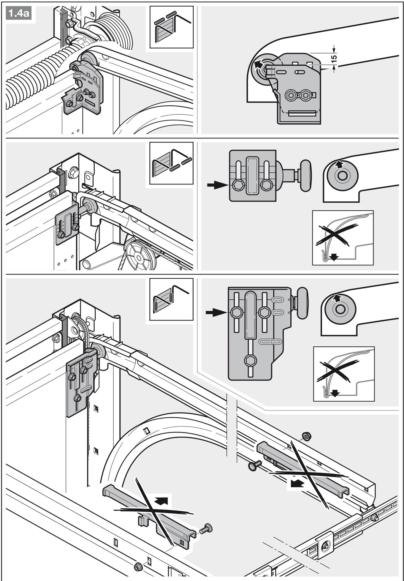
3. Bringen Sie bei Sectionaltoren mit einem mittigen Torverschluss das Sturzgelenk und den Mitnehmerwinkel außermittig an (max. 500 mm).
