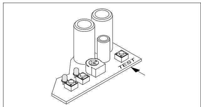
Jeder Tasterdruck bewirkt eine Bewegung des Tores. Taster „**TEST**“ drücken -> Tor läuft bis Endstellung.
