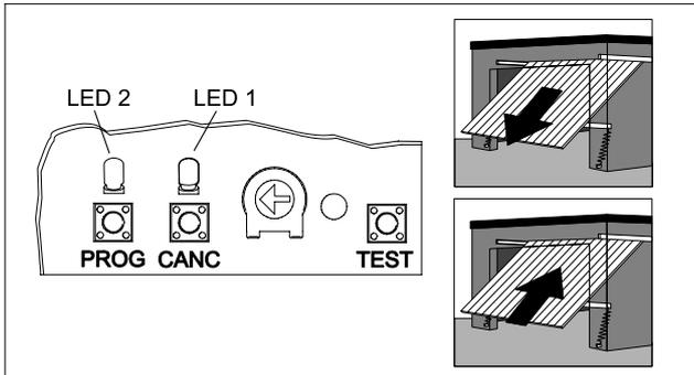
Während dieses Vorgangs „lernt“ die Steuerung die Endlagen des Garagentores, sowie die für den Öffnungs- und Schließvorgang benötigte Kraft. Hierzu sind folgende Schritte durchzuführen:
