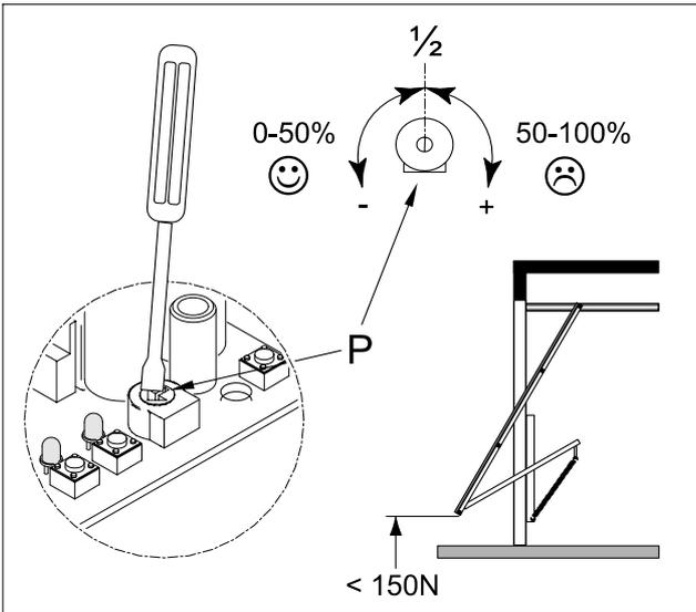
Die Zugkraft wird mit einem kleinen Schraubendreher an der Steuerung eingestellt. Sie muss so eingestellt sein, dass ein Gegendruck von 150 N (ca. 15kg) auf das sich schließende Tor zu einer Reversion führt und auf das sich öffnende Tor zu einem Stop führt.
