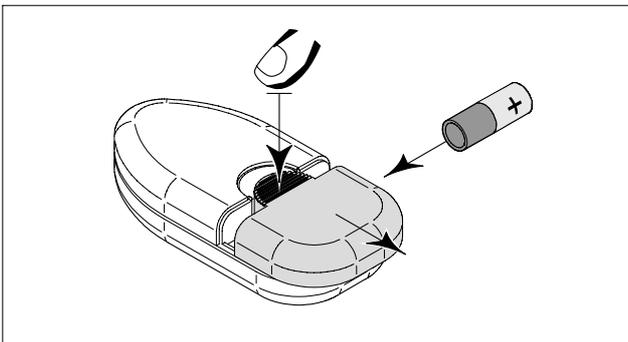
Die Abdeckung des Handsenders durch Drücken und Zurückziehen öffnen. Batterien austauschen. Die Polung der Batterie beachten!
