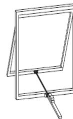
Befestigung an einem Klappfenster ohne Fensterbank mit Hilfe einer Endhalterung (Art. Nr. 40234 E).
