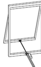
An Fensterkuppel mit Befestigung an der Vorderseite mit Hilfe einer Gleitschelle (40235 F).
