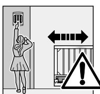
Instalowane na stałe urządzenia sterujące (sterowniki itp.) należy montować w miejscu, z którego brama jest widoczna, ale oddalonym od jej elementów ruchomych i na wysokości co najmniej 1,5 m.
