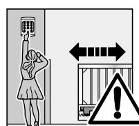
Festinstallierte Steuerungsgeräte (wie Taster etc.), sind in Sichtweite des Tores zu montieren, aber entfernt von sich bewegenden Teilen und in einer Höhe von mindestens 1,5 Metern.
