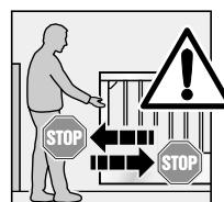
Visa alla personer som ska använda grindanläggningen hur denna används på ett korrekt och säkert sätt. Demonstrera och prova den mekaniska frikopplingen samt säkerhetsåtergången. Håll fast grinden med båda händerna vid stängning. Grindanläggningen ska bromsa in "mjukt" och inleda en säkerhetsåtergång. På samma sätt ska grindanläggningen bromsa in "mjukt" vid öppning och inleda en säkerhetsåtergång.
