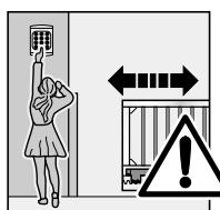
Les commandes installées à poste fixe (comme les claviers, les contacteurs à clé, etc..) doivent être placées à portée de vue du portail, mais à distance des parties mobiles et à une hauteur d'au moins 1,5 mètres.
