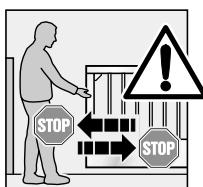
Leer alle personen die dehekinstallatie gebruiken hoe ze die correct en veilig moeten bedienen. Demonstreer en test de mechanische ontgrendeling en de veiligheidsterugloop. Houd daartoe het hek bij het sluiten met beide handen tegen. Dehekinstallatie moet "zachtjes" uitschakelen en de veiligheidsterugloop starten. Ook bij het openen moet dehekinstallatie "zachtjes" uitschakelen en de veiligheidsterugloop starten.
