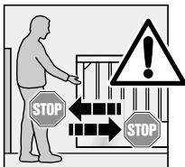
Weisen Sie alle Personen, die die Toranlage benutzen, in die ordnungsgemäße und sichere Bedienung ein. Demonstrieren und testen Sie die mechanische Entriegelung sowie den Sicherheitsrücklauf. Halten Sie dazu das Tor während der Zu-Fahrt mit beiden Händen an. Die Toranlage sollte "sanft" abschalten und den Sicherheitsrücklauf einleiten. Ebenso muss während der Auf-Fahrt die Toranlage "sanft" abschalten und den Sicherheitsrücklauf einleiten.
