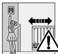
Los equipos de control fijamente instalados (tales como sensores, etc.) se tienen que montar a una distancia visible de la puerta, pero alejados de las piezas en movimiento y a una altura de al menos 1,5 metros.
