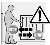
ENSEÑAR a todas las personas que utilicen la instalación de la puerta su accionamiento correcto y seguro. Demostrar y probar el desbloqueo mecánico y el retorno de seguridad. Para ello, detenga la puerta durante el desplazamiento de cierre con ambas manos. La instalación de la puerta deberá desconectarse "suavemente" e iniciar el retorno de seguridad. De igual forma tendrá que desconectarse "suavemente" durante el desplazamiento de apertura e iniciar el retorno de seguridad.
