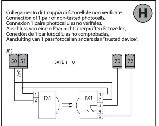
\*\*Con logica inversione direzione di apertura = 000 (DIR=DX) / \*\*With reverse logic, opening direction = 000 (DIR=right)
