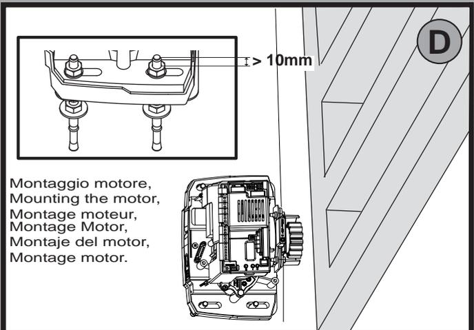
Montaggio motore, Mounting the motor,
