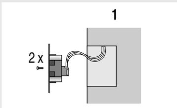
1.) Anschlussleitungen an den Klemmen des Steckrahmens anschließen (Klemmenbelegung siehe 2.2) und Steckrahmen in U.P.-Dose befestigen.
