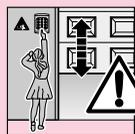
Les appareils de commande fixes (p. ex. boutons-poussoirs), doivent être installés en vue de la porte, mais à l'écart des pièces mobiles et à une hauteur de minimum 1,5 m. Ils doivent absolument être installés hors de portée des enfants!
