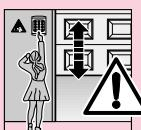
O equipamento de comando fixo (como por exemplo, sensores, etc.) terá de ser montado no raio de visibilidade do portão mas longe das peças móveis com uma altura de, pelo menos, 1,5 m. Terão de ser montados fora do alcance das crianças!
